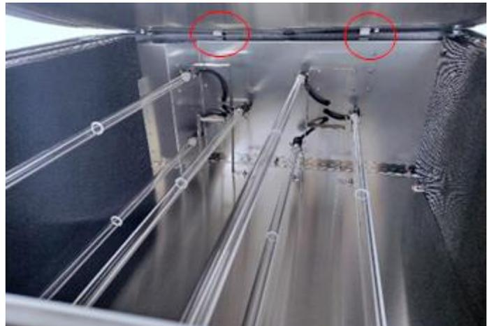
**WICHTIG:** Stecken Sie anschließend das Erdungskabel wieder am Deckel an (vgl. „Öffnen und Schließen des Gerätes“ Schritt IV.) und schließen Sie diesen.
