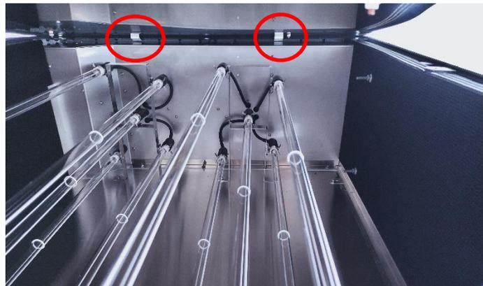
**WICHTIG:** Stecken Sie anschließend das Erdungskabel wieder am Deckel an (vgl. „Öffnen und Schließen des Gerätes“ Schritt IV.) und schließen Sie diesen.
