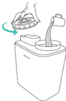
4. Füllen Sie den Wassertank mit Wasser, schrauben Sie den Wassertankdeckel wieder fest und befestigen Sie den Wassertank sicher am Unterteil. Der Wassertankstand kann im Fenster auf der linken Seite abgelesen werden.
