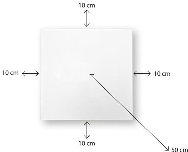
3. Die Heizung darf nur mit der mitgelieferten Halterung an der Wand oder der Decke angebracht werden.
