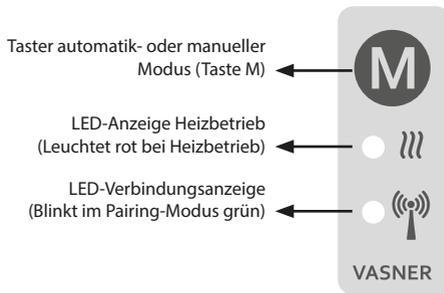
Im Funk-Automatik-Modus ist die Funkeinheit aktiviert und kann schnell und einfach mit dem VASNER RX Funk-Thermostatsender verbunden werden, über welchen Sie die Heizung direkt steuern können. Nutzen Sie hierzu bitte den VASNER RX Funk-Thermostat-Sender, welcher separat erhältlich ist.
