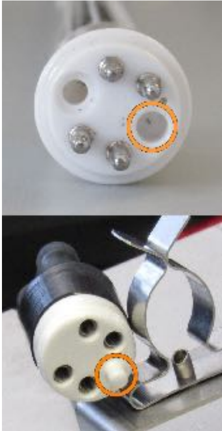
Abb. 20: Oben UV-Strahler, unten Stecksocket mit Sicherungstift
