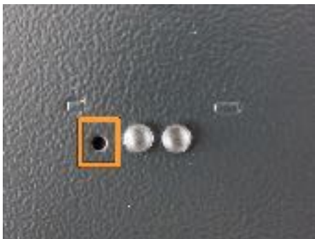
Abb. 21: Reset-Taster (Öffnung neben LEDs)
