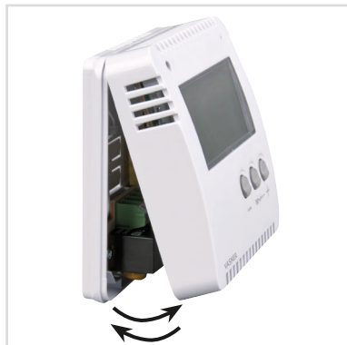
Abb.4 Das Bedienteil oben einhaken und zuklappen. Danach die Gehäuseschraube anziehen.
