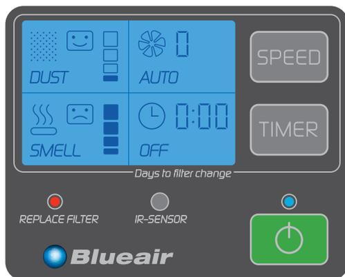
**POWER ON/OFF.** Die grüne POWER-Taste zum Ein- und Ausschalten des Gerätes betätigen. Das Gerät läuft nach der Einschaltung fünf Minuten lang automatisch mit der höchsten Drehzahl, damit eine schnelle Anfangsreinigung sichergestellt ist, und schaltet dann auf Auto Mode um.
