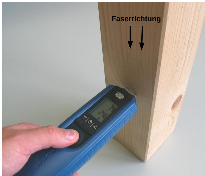
Abbildung 4-1 Messung quer zur Faserrichtung
