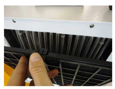
Der Luftfilter ist beim Lufteinzug in einem schwarzen Kunststoffrahmen eingesetzt. Er filtriert Flusen, Haare und groben Staub und sorgt so dafür, dass dieser Schmutz nicht wieder in die Raumluft geblasen wird. Ferner sorgt der Luftfilter dafür, dass sich weniger Staub auf den Kühlrohren ablagert und gewährleistet so eine höhere Effizienz.
