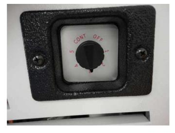
Für allgemeine Feuchtigkeitsregulierung Position 3-4 (Zone 50-60% Restfeuchtigkeit) Für Wäschetrocknung Position 5 (Zone 40% Restfeuchtigkeit) Für Endlosbetrieb Position "CONT" (Continous = Endlosbetrieb)
