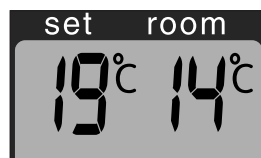
F: A gauche la température désirée, à droite la température mesurée.
