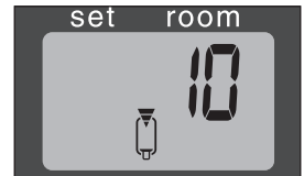
J: Wenn die FUEL-Anzeige aufleuchtet sehen Sie im Informations-Display für wieviel Minuten Sie noch Brennstoff haben.
