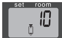
J: Als 'FUEL' indicatie brandt, ziet u in het informatiedisplay voor hoeveel minuten u nog brandstof hebt.
