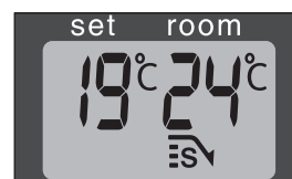
I: När SAVE-lampan tänds stängs värmaren av eller slås på automatiskt för att hålla sig inom ett specificerat temperaturintervall.
