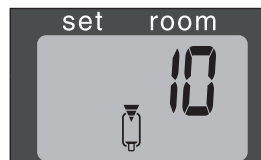
J: Når drivstoffindikatoren lyser, viser informasjonsdisplayet hvor mange minutter ovnen kan brenne før beholderen er tom.
