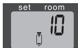
J: När FUEL-indikatorn har dykt upp visar informationsdisplayen hur många minuters brinntid bränslet som är kvar i bränsletanken räcker till.
