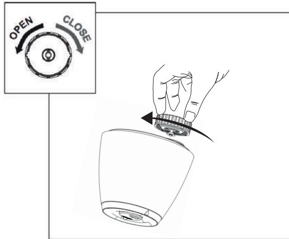
4. Fermer le couvercle du réservoir, en le tournant vers la droite. Il est important de fixer SOLIDEMENT le bouchon après avoir rempli le réservoir avec de l'eau.
