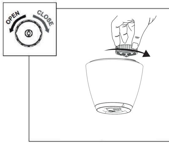
2. Retourner le réservoir d'eau et ouvrir le bouchon du réservoir, en le tournant vers la gauche.
