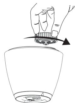
2. Stürzen Sie den Wassertank und öffnen Sie den Tankdeckel, indem Sie diesen nach links drehen.
