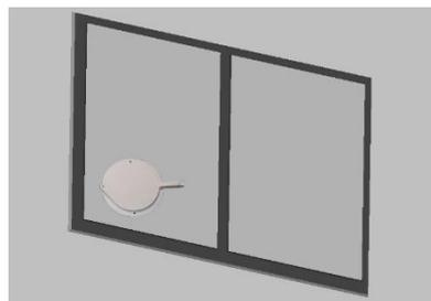
3. Setzen Sie den Adapter ohne den Verschlussdeckel in das Fenster ein. Setzen Sie den runden Anschluss für das Fensteradapter-Set in den einziehbaren Schlauch ein und fügen Sie den einziehbaren Schlauch mit dem runden Anschluss in den Fensteradapter.
