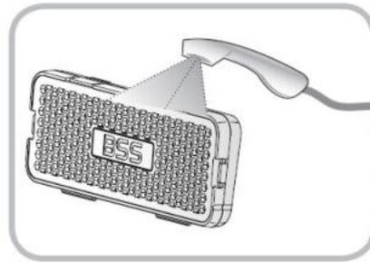
Das Gerät muss zuerst ausgeschaltet und vom Netz getrennt werden. Danach den Oberteil abnehmen. Den BSS-Filter aus dem Wasserbehälter herausnehmen und mit Wasser spülen.
