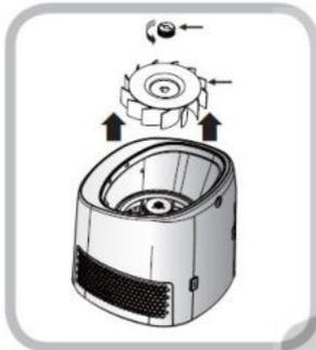
Den Ventilator durch Lösen des Ventilator-Fixverschlusses im Uhrzeigersinn abschalten.
