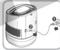
Wenn das Speisekabel getrennt wird, muss es zuerst aus der Steckdose herausgezogen und erst danach vom Gerät getrennt werden.
